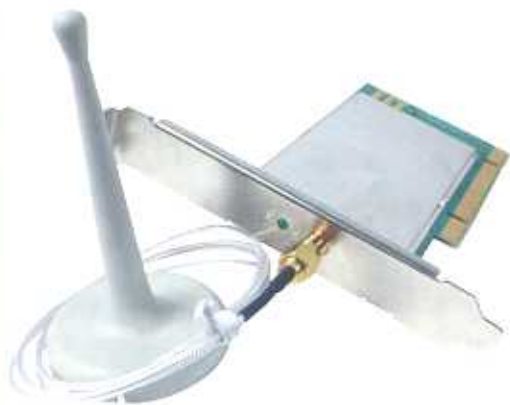
การ์ดเครือข่ายไร้สายที่ติดตั้งบนการ์ด PCI และมาพร้อมกับเสาอากาศ
